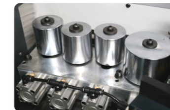
a. 通过四个压贴轮进行加压，使板材和封边带贴合更加牢固
