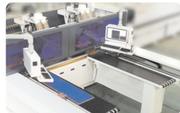
a. 双工位上下4个钻包 可同时加工不同尺寸板件
