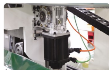
b. 锯车速度可达120m/min锯座 驱动伺服电机高速裁板，稳定高效
