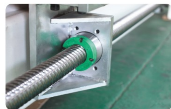
a. 采用滚珠丝杆传动，板件完成孔、槽等工艺后，板件精度误差为±0.02mm
