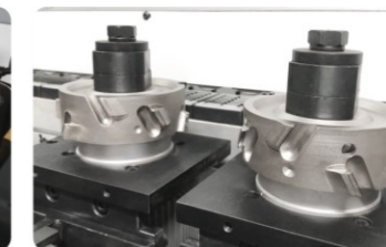
b. 预铣单元使封边条与板材贴合更紧密，整体性和美观度更佳
