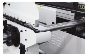
a.同步输送装置，标准化封边流程 柔性化封边更省事更灵活
