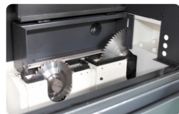
b. 小锯可根据不同锯切高度、 宽度，实现自动定位锯切行程
