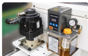
b.伺服电机+集中注油装置 使设备在运行中更平稳顺畅
