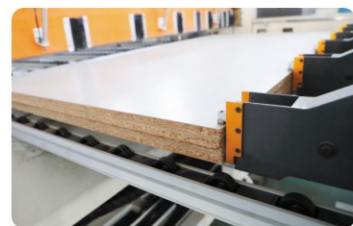
a. 采用灵活的裹胶双指结构，小 板件夹板送料更稳定
