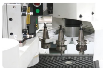
b.斗笠式刀库可以装12把刀 就近原则自动换刀铣型更高效
