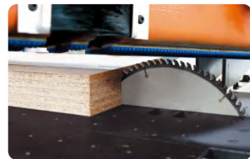
a. 最大纵切长度3300mm, 最大横切长度1800mm
