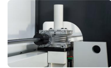
a.采用独立式涡轮蜗杆升降和精密滑动块传动，大幅度提高升降各单元稳定性与同步性
