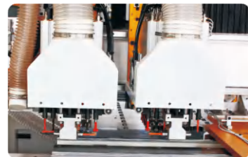
a. 一次加工可完成六面所有孔位及 双面槽位实现快速高效钻铣工作
