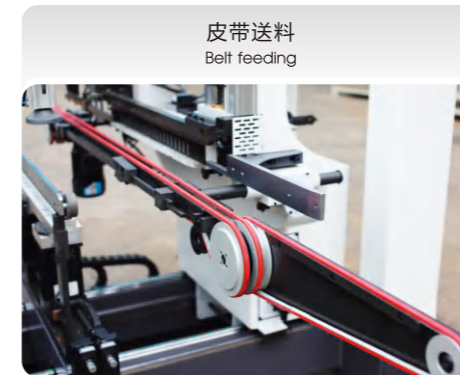
a. 皮带式自动送料装置 输送稳定更耐磨
