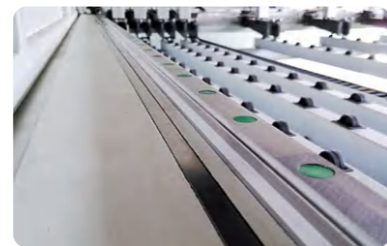
b. 采用台湾上银精密直线滑轨，自润设计无须人工添油
