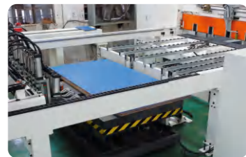
a. 辊轮助力板料运动，轻松传送板件，保护板材表面，防止板材刮花
