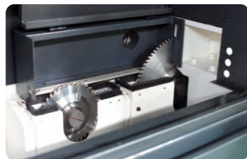
b. 根据板材厚度，自动定位锯切行程， 减少空跑时间，锯座速度120m/min
