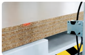
b. 带红外线感应装置，升降台持续保持设定高度，平稳上料
