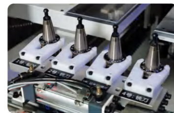
b. 自动换刀直排刀库连续高效加工, 满足多种加工需求
