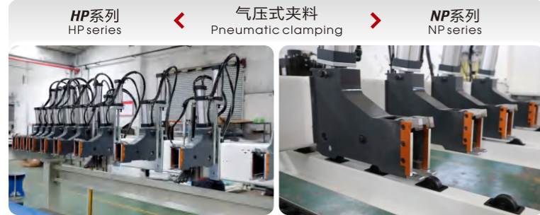
采用行业领先的双指夹料结构，板料夹料采用气缸，且送料前经过滚轮床面，确保尺寸锯切精度且不会伤及工件表面
