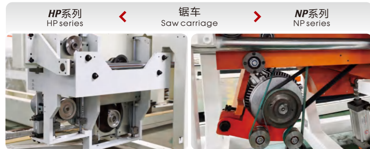
大小锯独立升降，可根据不同锯切高度、宽度实现自动定位锯切行程，标配18.5KW主锯电机，锯片快速装卸，有效减轻工人负担
