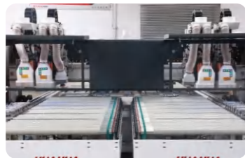
a. 六钻包高效加工, 4个高精密上钻包 + 2个下钻包加工六面打孔、拉槽和铣型, 效率比常规双工位提升20%
