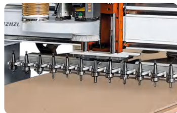
a.十二把直排刀库，每个功能一把刀，自动换刀无需等待
