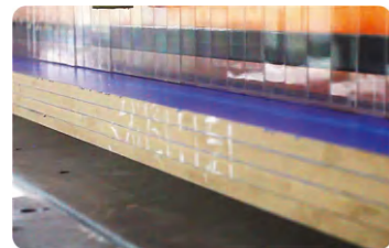
a. 自动打下防尘挡板，防止锯切过程中所产生的边料和尘屑
