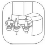
b. 自带刀库 Tool magazine
