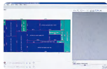
a. HHM控制软件，可编辑管理锯切方案，模拟和执行锯切
