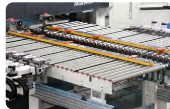
b. 首创八夹手、首创双重定位、首创送料推手, 送料滚筒一体设计, 快速送料, 伺服电机控制, 靠板精准定位
