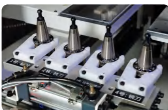
b. 自带四刀库, 可用拉米诺锯片, 普通锯片, 和常规钻头, 可加工三合一、拉米诺、灯线槽、拉直器、隐形拉手等工艺
