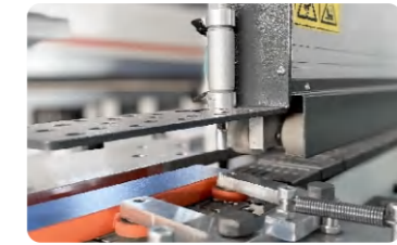
a. 小板辅助送料装置，最小可以完成端头板45*200mm长窄边40*300mm封边加工。
