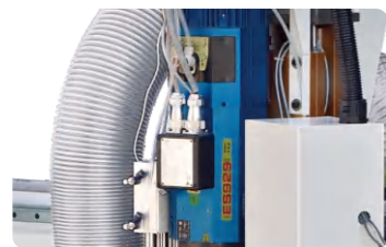
a. 风冷主轴电机，配合刀库，无需等待换刀时间快速加工，效率更高
