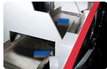
a. 废料回收通道，输送锯切产生的废料，防止废料堆积影响机器正常运作
