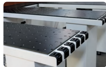
a. 工作台进料采用气动浮珠台面 保护板材表面，防止板材刮花
