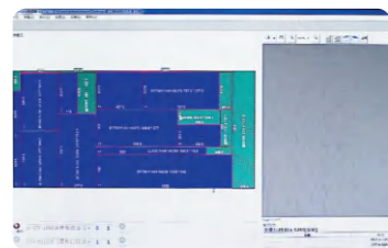
a.HMM控制软件，可编辑管理锯切方案，模拟和执行锯切
