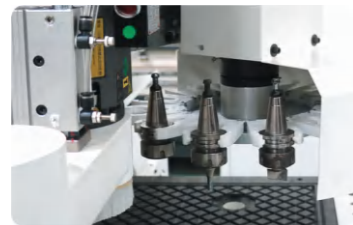
b.斗笠式刀库可以装12把刀 就近原则自动换刀铣型更高效
