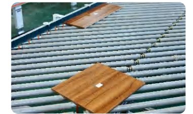
b.左右输送装置，通过式加工，缩短板间距，让每台封边机利用率最大化
