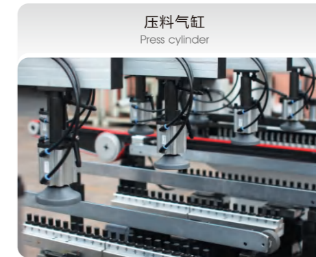
b. 气动压料，精准打孔，板件在加工过程中精准定位不易打偏
