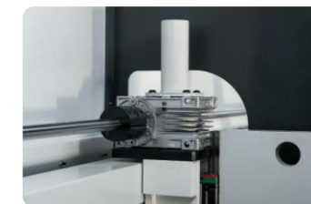
a. 采用独立式涡轮蜗杆升降和精密滑动块传动，大幅度提高升降各单元稳定性与同步性
