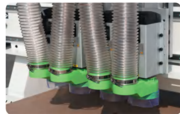
a.四主轴可用作开槽、铣型、垂直钻孔、钻铣等工艺
