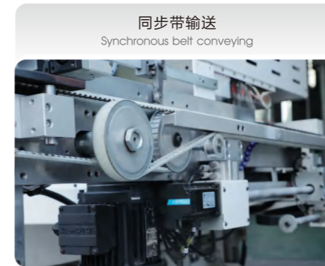
a. 同步带输送装置 输送稳定，效率更高
