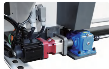
b. 左右输送装置，通过式加工，缩短板间距，让每台封边机利用率最大化
