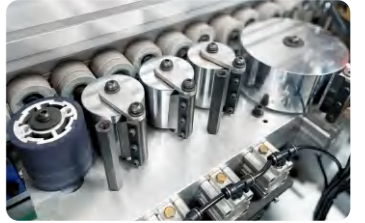
b. 4个强力压轮+1个胶轮，加大压轮直径为150mm，自带刮刀喷洗余胶，胶轮包覆性更好，贴合更紧密
