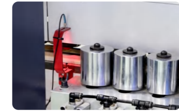
a.采用红外线测距 为保证加工精度
