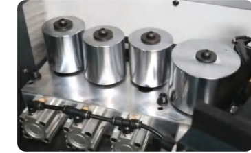
a.通过四个压贴轮进行加压，使板材和封边带贴合更加牢固
