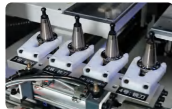
b. 采用4位直线刀库,根据不同工艺需求自动更换相应刀具
