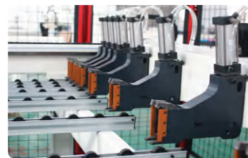
b.采用灵活的裹胶双指结构，小板件夹板送料更稳定
