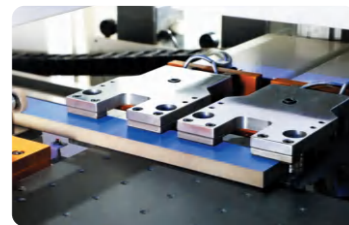
b. 采用双夹手机构，根据电脑钻孔 程序，自动控制送板及定位
